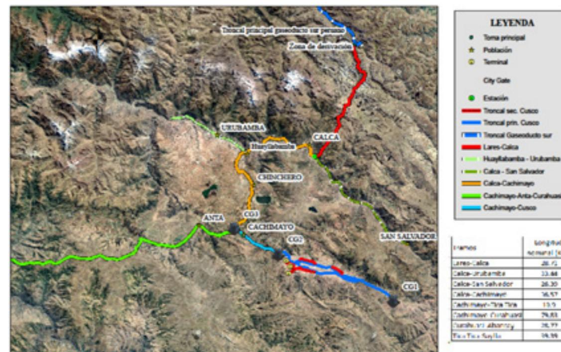
Propuesta de Masificación mediante red de ductos: en una primera etapa con gas virtual para luego conectarse al SIT GAS (basado en un análisis de ingeniería conceptual y en actual estudio)
